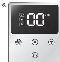
Quando passar o último litro de água quente e a contagem chegar a zero, automaticamente o aquecedor deixará de aquecer a água e emitirá um beep para lembrar que o registro de água quente da banheira seja fechado, evitando o transbordamento. Após fechar o registro, o aquecedor sairá automaticamente desta função.
